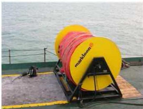
Maksimalna sigurnost rukovanja Markleen hidrauličkim vitlima postignuta je zahvaljujući upravljačkoj ploči opremljenoj razvodnim ventilom koji kontrolira smjer rotacije, brzinu rotacije (podesivo između 0 i 12) i hidraulička kočnica.
