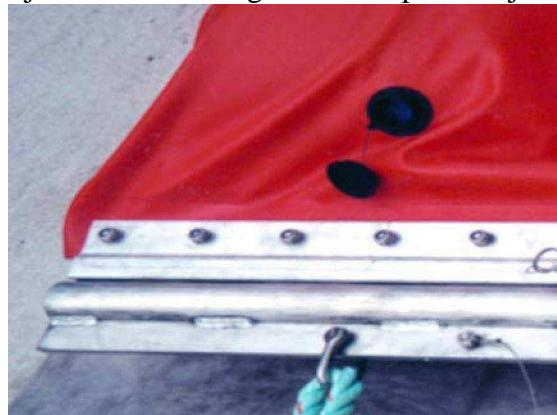
Također, kada se zadnja komora puni na kraju svake dužine,drenažni ventil mora biti otvoren i zatvoren kad je napuhavanje gotovo.
