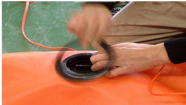
9- Namjestite prvo ventil na vanjski materijal na brani i zatim na komoru unutra. Stavite ventil postrance koristeći ureze za pomoć.
