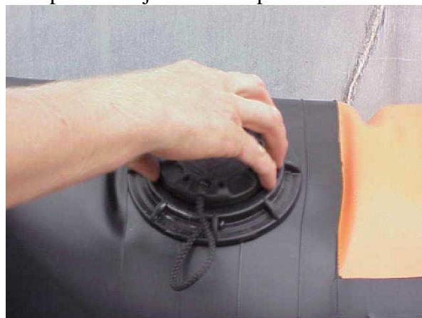
3.- Postavite crijevo kompresora u ventil. Gurnite ga u ventil i okrenite u smjeru kazaljki na satu koliko god ide.
